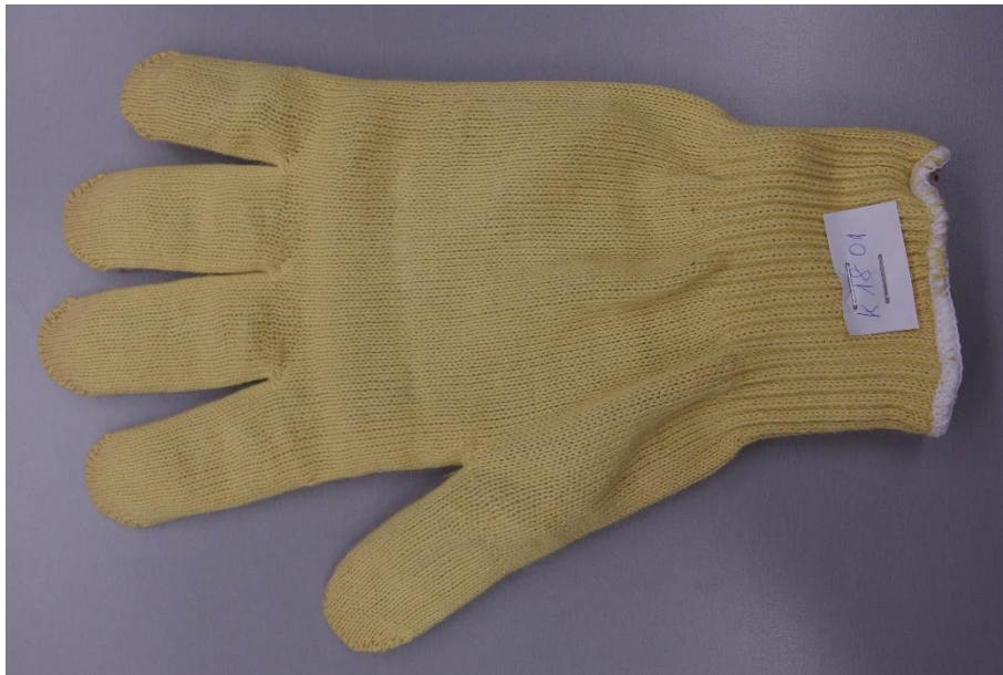
23. ábra: Kétrétegű kesztyű prototípus, K1801 jelű változat.(3. minta)
