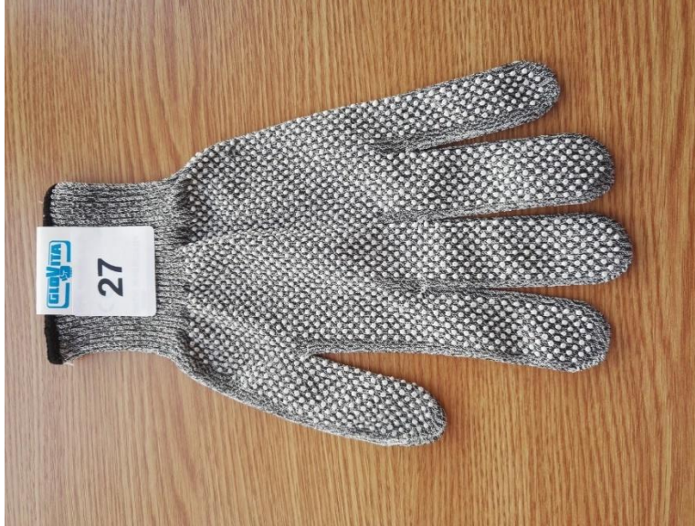
42 ábra: PA/PES/üvegszál fialátmentes kesztyű, pamutbéléssel (27. minta)
