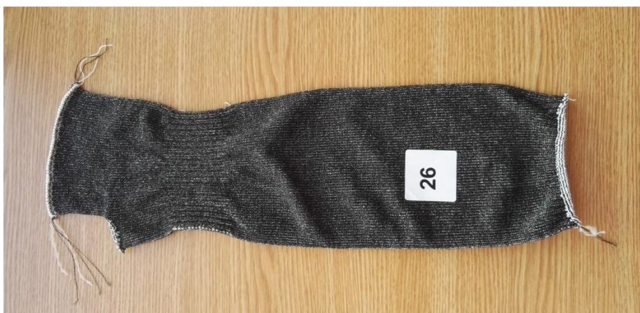
41 ábra: PA/PES/üvegszál lábvédő pamutbéléssel (26. minta)
