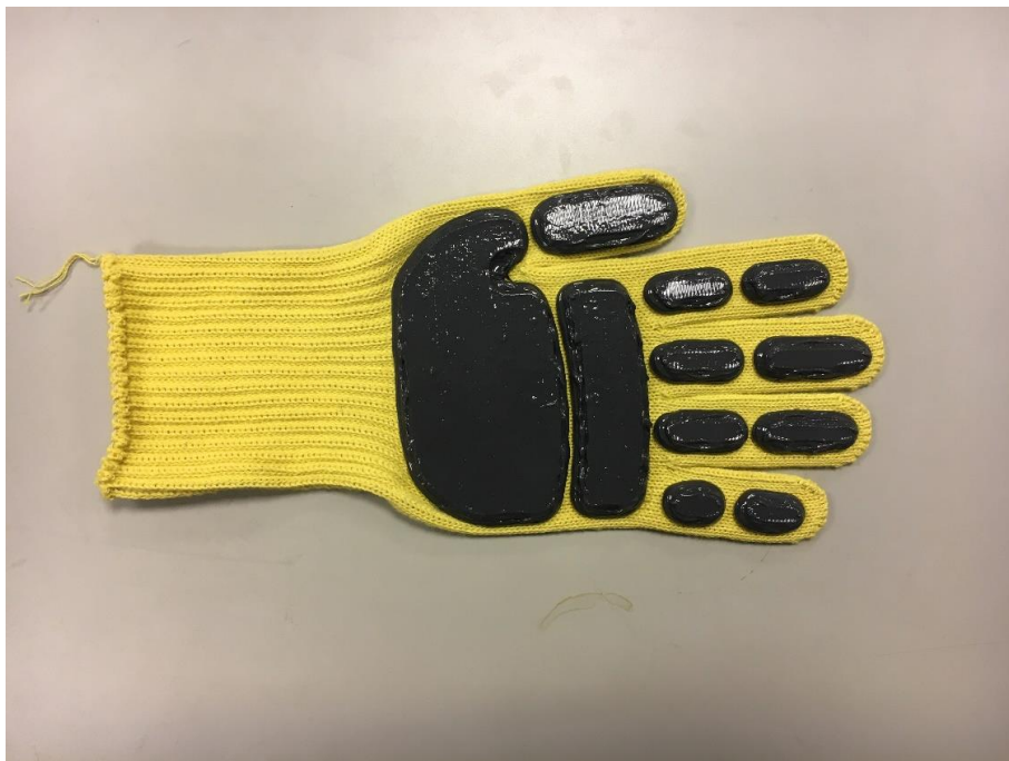
34 ábra: Egyrétégű kesztyű prototípus, 3D nyomtatással készült szilikon lapocskákkal (K3D2)(16. minta)
