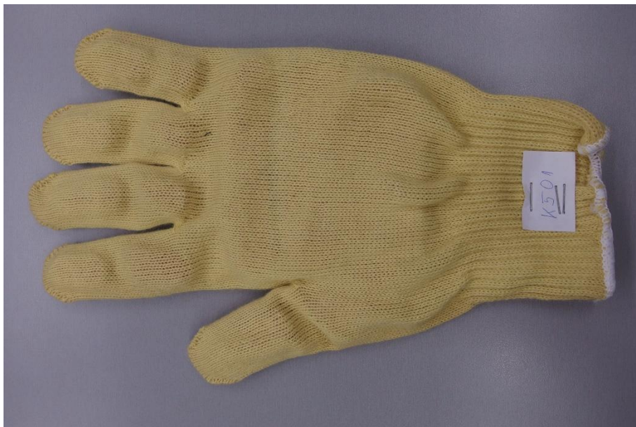
24. ábra: Kétrétegű kesztyű prototípus, K501 jelű változat (4. minta)
