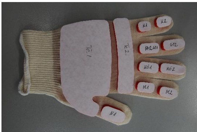
3. ábra: Rezgésvédelem céljára lézervágott alkatrészek elhelyezése a kesztyűn
