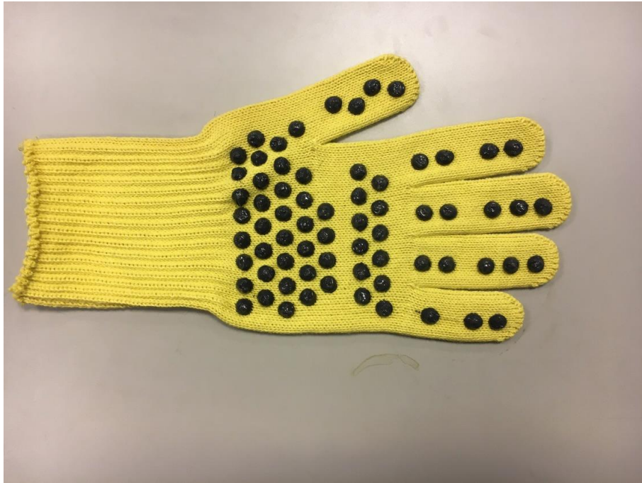
33 ábra: Egyrétégű kesztyű prototípus, 3D nyomtatással készült szilikon „bütykökkel” (K3D1), (15. minta)
