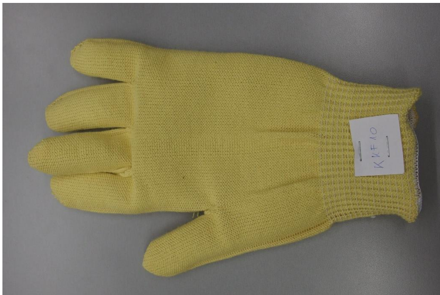
30. ábra: Kétrétegű kesztyű minta, KKF10 jelű változat (12. minta)
