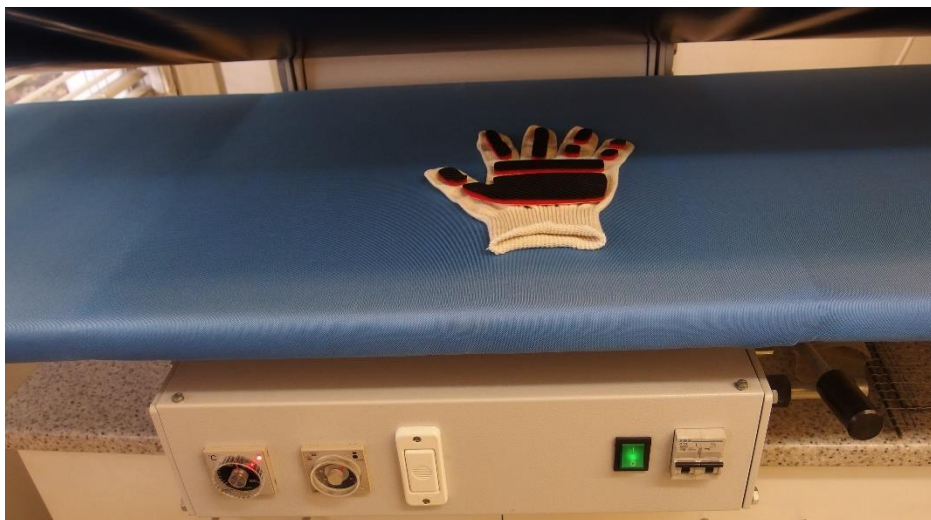
4. ábra: Rezgésvédelem céljára lézervágott alkatrészek hőrögzítése a kesztyűn
