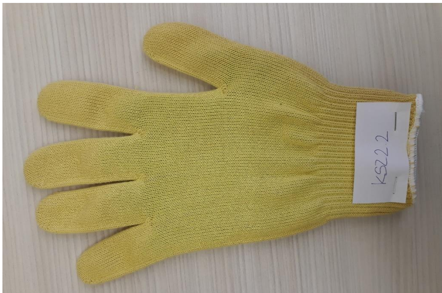
38. ábra: Kevlar kesztyű prototípusa, kétrétegű zöld szilikonnal és pamutbéléssel (KSZ22) (23. minta)
