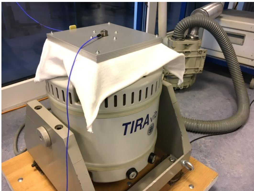
17. ábra: 11553-370 jelű anyagminta merevségének mérése
