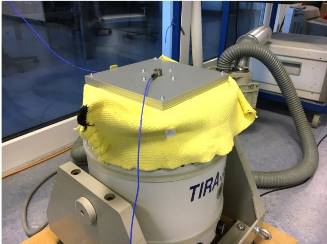
16. ábra: 211773-242 jelű anyagminta merevségének mérése
