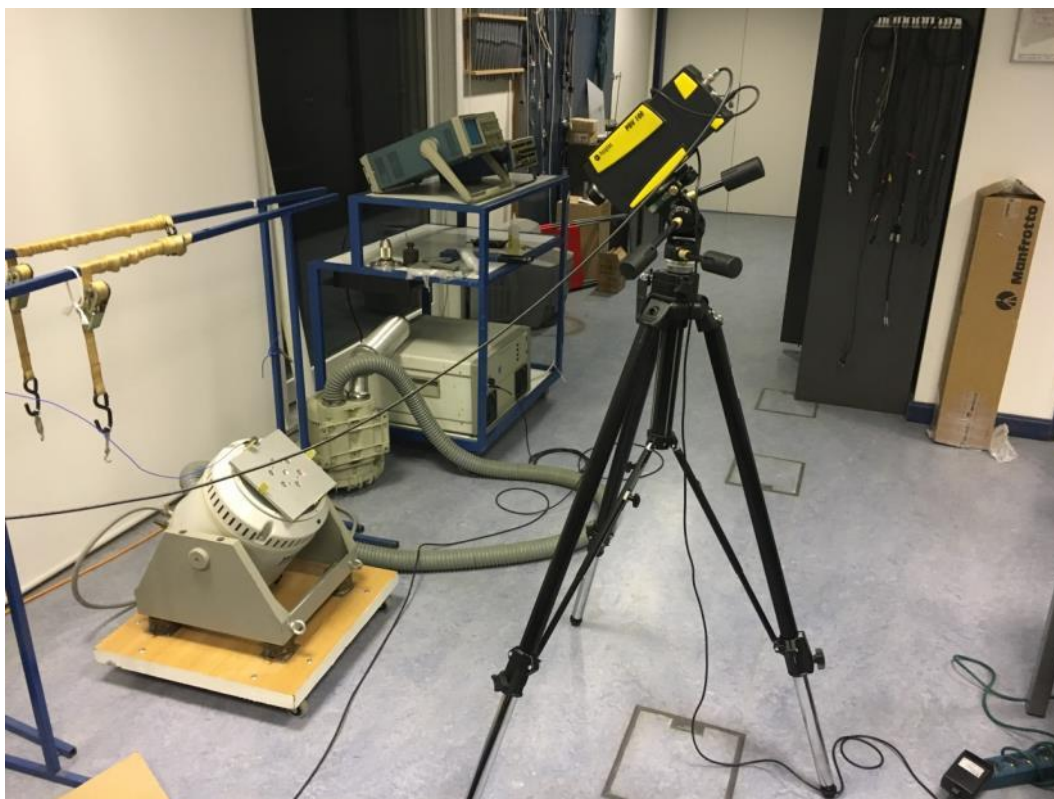
12. ábra: Az alapelem sajátrezgéseinek ellenőrzése Polytec PV-100 típusú lézeres rezgésmérő segítségével
