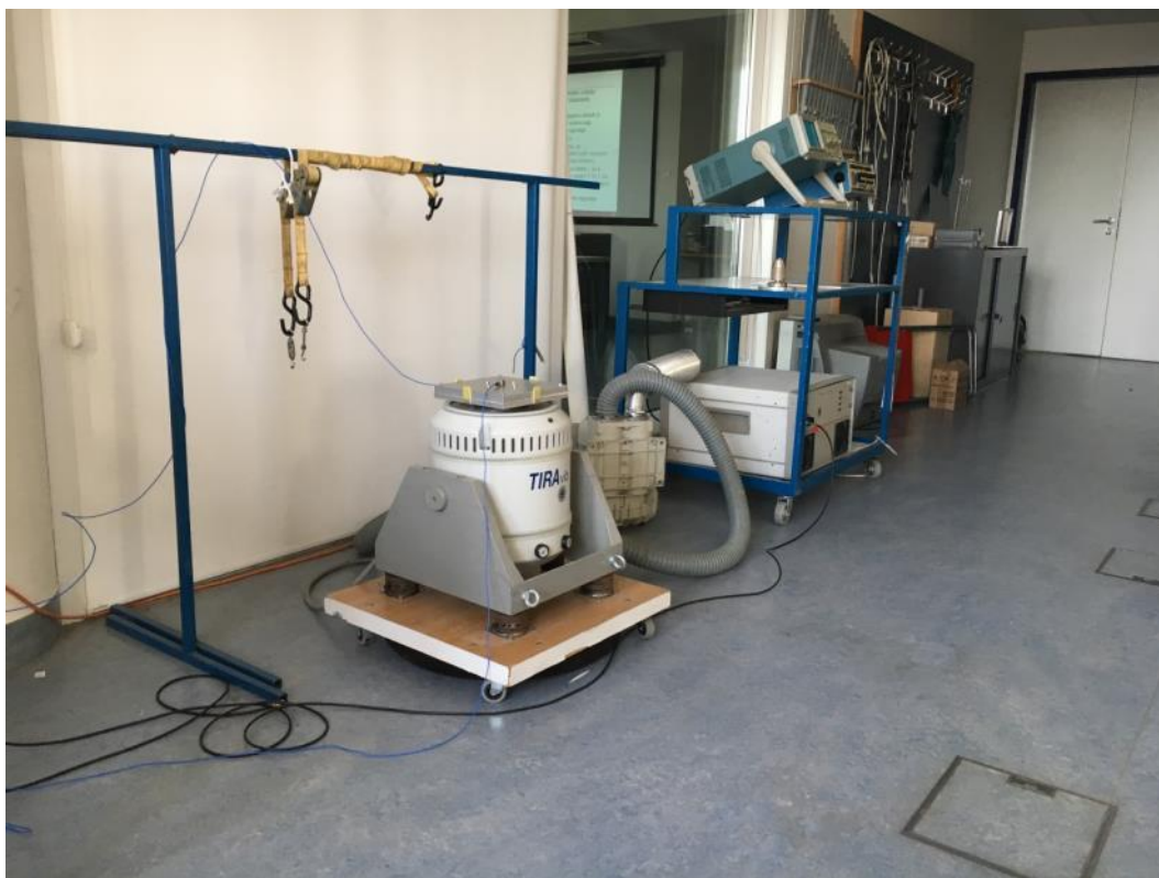
11. ábra: Rugalmasan alátámasztott shaker hűtőventilátorral és teljesítményerősítővel
