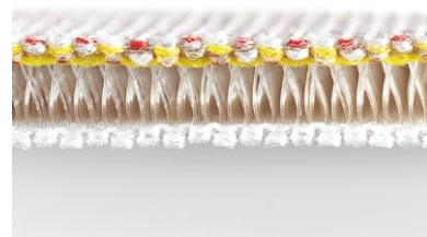
6. ábra Üreges textil keresztmetszete [6]
