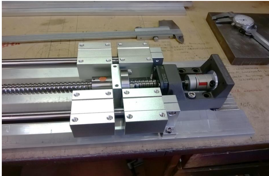
1. ábra A késmozgatás alkatrészei: Golyósorsó, golyós vezeték, kocsik, motortartó konzol, tengelykapcsoló kialakítása
