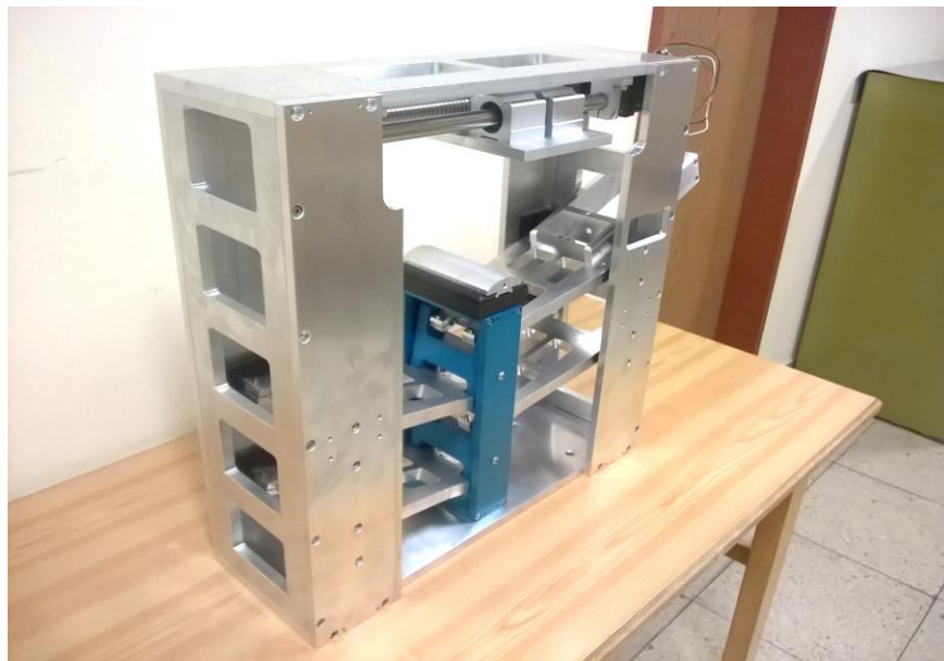
4. ábra Baloldali nézet a súlytartó karral és a léptetőmotorral
