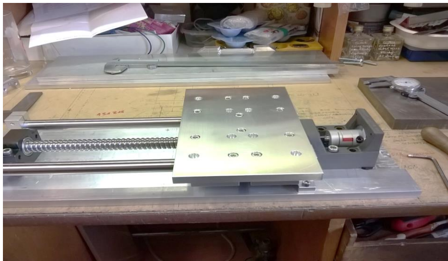
2. ábra keresztirányú késmozgatás alaplapja
