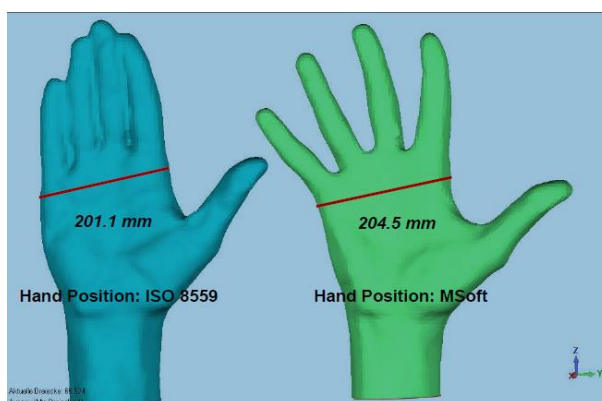
17. ábra Kéz méretének meghatározása az ISO 8559 szerint és testszkennerrel
